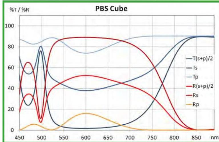
偏振分光棱镜立方体目前应用广泛，在测量上仍具有挑战性的光学组件之一。上图所示，前表面未镀膜的偏振分光棱镜在无人值守的情况下2分钟内被测量完毕，在进行 $T_s/T_p$ 和 $R_s/R_p$ 测量时可以确保入射光束落在立方体相同的点上
