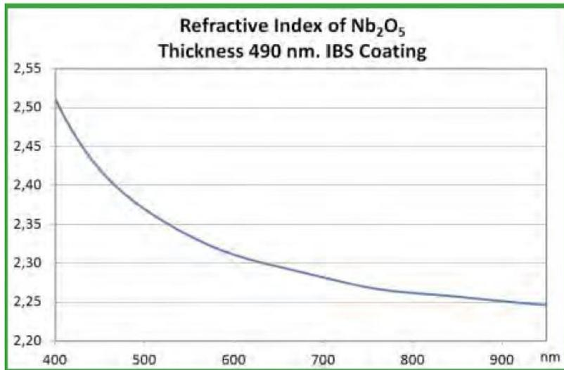
单层膜可以用内置的专利软件进行测量，该软件的特点可以对复折射率和膜层厚度进行连续的瞬时计算。上图显示了 $\text{Nb}_2\text{O}_5$ 膜层的复折射率以及膜层厚度（490nm），膜层通过离子溅射技术产生
