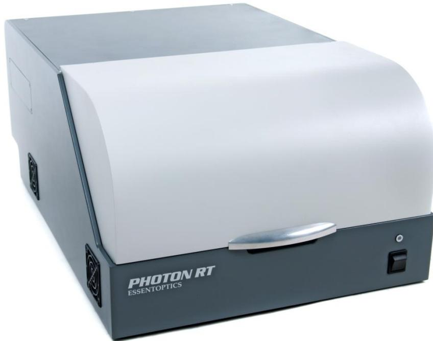
Photon RT 是专门为光学镀膜测试设计的仪器。内建宽谱带高对比自动偏光镜可以对紫外（185nm）到中波红外（5200nm）波段实现多角度和偏振态精确测量。
